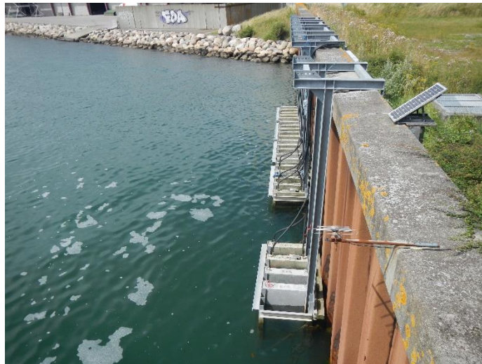
Figure 4. Échantillons de bétons contenant des cendres volantes soumis à l'environnement agressif pour plusieurs années.
